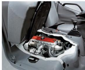
СЪЕМНАЯ ПАНЕЛЬ ДЛЯ ОСМОТРА ДВИГАТЕЛЯ
