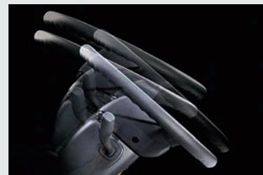
**РЕГУЛИРОВКА РУЛЕВОЙ КОЛОНКИ в 2-Х НАПРАВЛЕНИЯХ**
