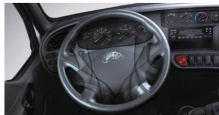
Гидравлический усилитель руля и регулируемая по высоте и наклону рулевая колонка
