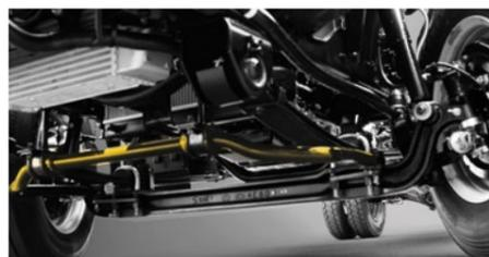
Передний и задний стабилизатор поперечной устойчивости
