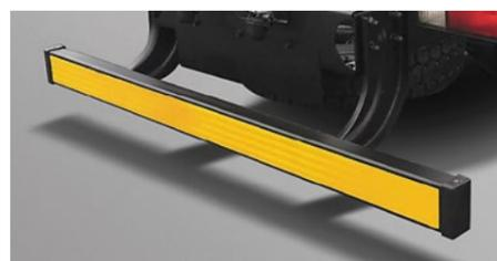
Задний противоподкатный брус
